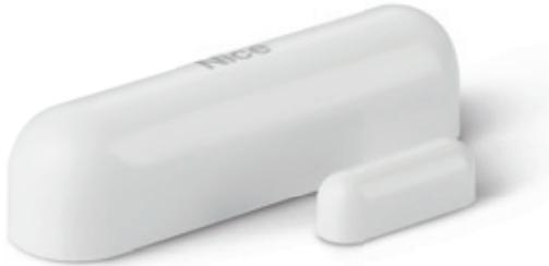
D/W-Control est un capteur à contact magnétique sans fil, fonctionnant sur pile. L'ouverture est détectée par la séparation entre le corps du capteur et l'aimant. Le capteur peut être utilisé en combinaison avec Yubii Home pour déclencher des scénarios et partout où des informations sur l'ouverture ou la fermeture de portes, fenêtres, portes de garage, etc. sont nécessaires. De plus, D/W-Control est équipé d'un capteur de température intégré.
