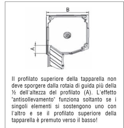
Il profilato superiore della tapparella non deve sporgere dalla rotaia di guida più della  $\frac{1}{2}$  dell'altezza del profilato (A). L'effetto "antisollevamento" funziona soltanto se i singoli elementi si sostengono uno con l'altro e se il profilato superiore della tapparella è premuto verso il basso!
