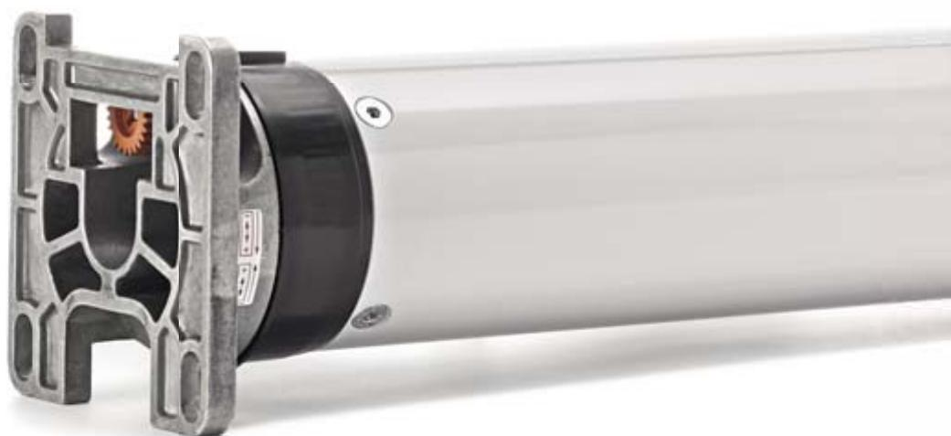
Nuestro tipo 15 W... es el motor ideal para persianas pesadas, pequeñas puertas enrollables y verjas enrollables. Se caracteriza por sus pares equilibrados, 120 Nm, 150 Nm, 180 Nm, 230 Nm y 300 Nm, con 230 V/50 Hz cada uno.
