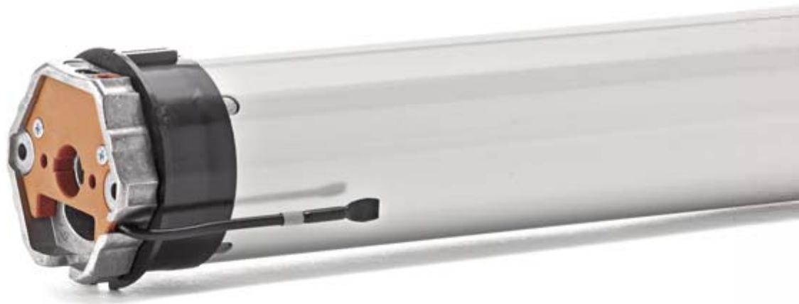
Los motores tubulares de la serie L están disponibles en las variantes RolTop, SunTop y VariEco, tanto sin sistema de radio integrado como con él. Así, elero ofrece una amplia gama de productos que cubre un sinfín de aplicaciones. Con un diámetro de 55 mm, los motores presentan un diseño óptimo para sistemas que ahorran espacio. Hay disponibles motores de 40 a 80 Nm, y 14 rpm. Todos los motores se montan y ajustan de manera sencilla y ahorrando tiempo.
