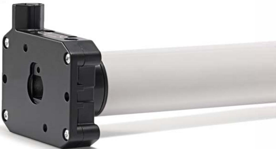
Los motores tipo 9 NHK y tipo 11 NHK de elero ofrecen un manejo óptimo de puertas, persianas y toldos. Se caracterizan por unos pares equilibrados que van desde 8 hasta 50 Nm (tipo 9 NHK) y desde 40 hasta 120 Nm (tipo 11 NHK). Incluso en caso de fallo de la red eléctrica, el sistema puede manejarse sencillamente mediante una manivela. La desconexión final mecánica es fácilmente ajustable, independientemente de si esta montada a la izquierda o a la derecha.
